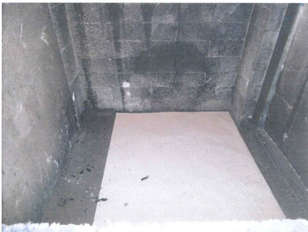
18. minuta zkoušky, pohled na kontrolní papírovou podložku
